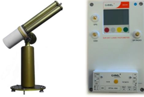
Figura 2.1: Fotómetro CIMEL C318-T, compuesto por el robot y la cabeza sensora (a la izquierda) y la caja de control (a la derecha). Figura extraída de Almansa (2021).
