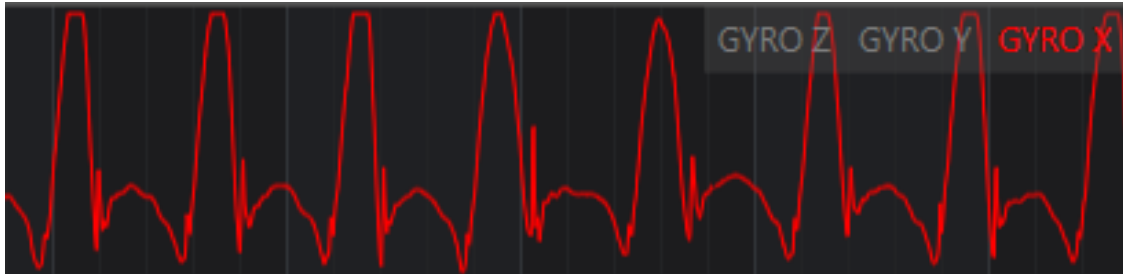
Figura 5. Velocidad angular en x medida desde un sensor colocado en el tibial
