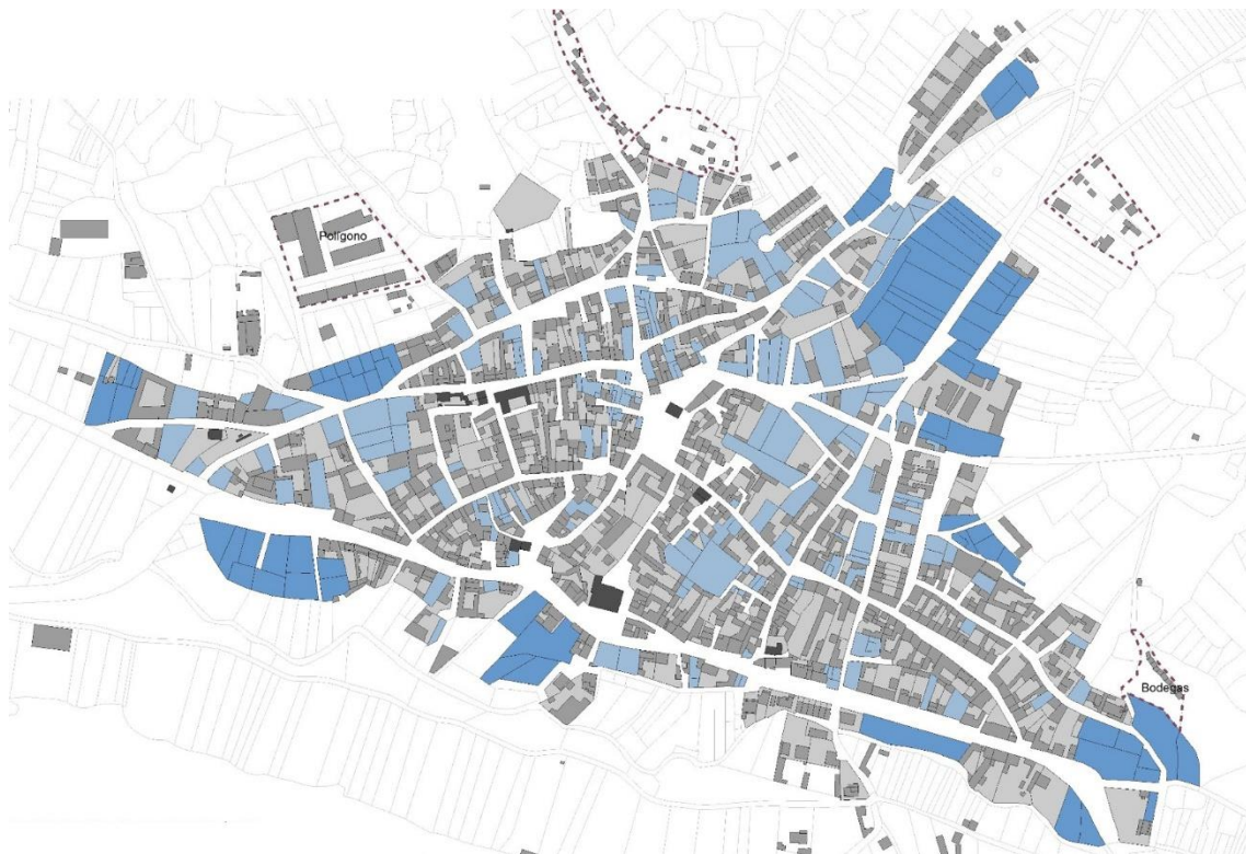
Fig. 7 Definición de situaciones urbanísticas básicas en el núcleo de San Miguel del Arroyo: se destacan los vacíos urbanos interiores (en azul claro) y los bordes urbanos (en azul oscuro), así como ciertas situaciones singulares en suelo rústico (con línea de puntos). Fuente: Elaboración propia a partir de cartografía catastral.
