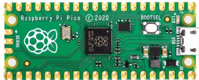
Figura 27. Raspberry Pi Pico [17](Raspberry Pi Pico Datasheet, s. f.).
