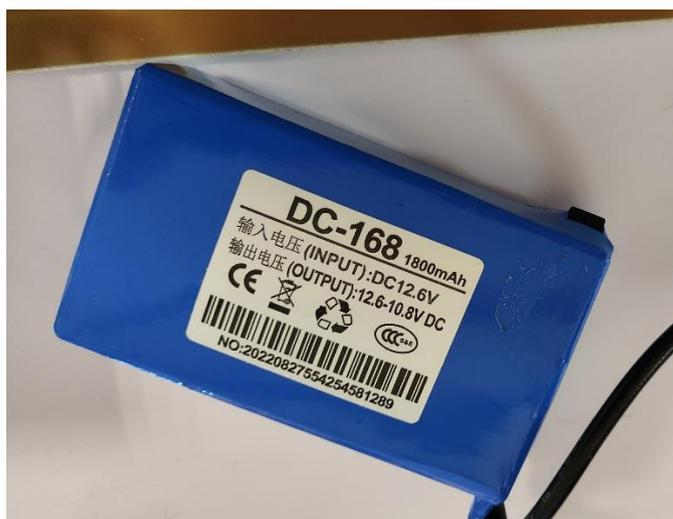
Figura 53. Batería DC utilizada en el prototipo de la prótesis [6](Eleoption - DC-168, CD 12 V, 1800 mAh, s. f.).
