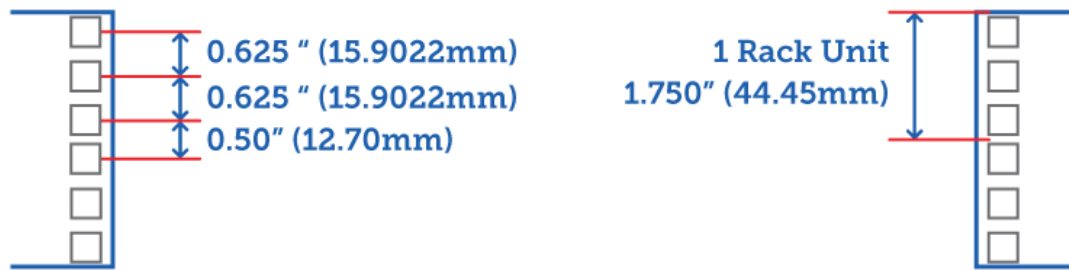
Figura 31 - Dimensiones de unidades rack Fuente: - [55]
