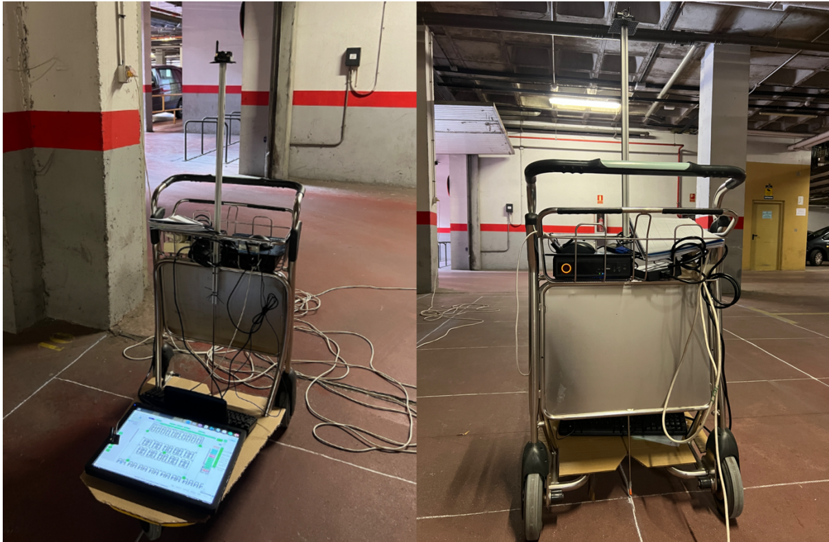
Figura 29. Toma de medidas en la cuadrícula de pruebas con el carro.
