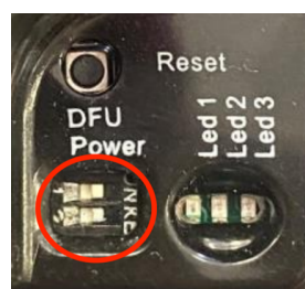
Figura 15. Switches que permiten cambiar entre modos de funcionamiento en las balizas.
