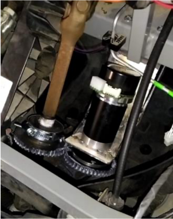
Figura 2.11: Implementación del conjunto del motor, los engranajes y el soporte en el Twizy.
