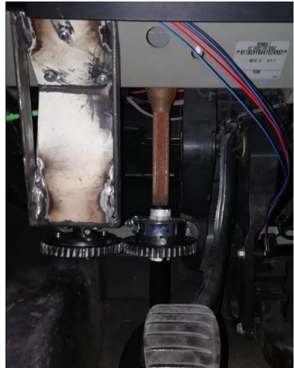
Figura 2.11: Implementación del conjunto del motor, los engranajes y el soporte en el Twizy.
