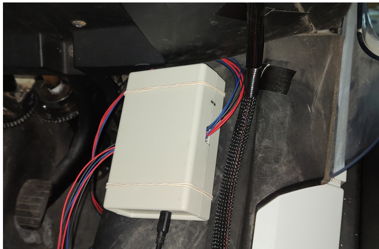
Figura 3.10: Disposición final del controlador del acelerador
