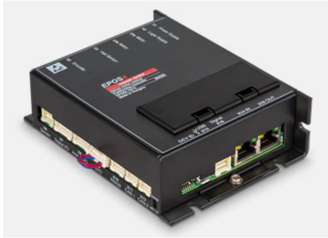
Figura 1.6: Controladora EPOS4 Maxon Motor[7]
