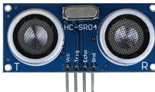
*Figura 30. Sensor de ultrasonido HC-SR04 [51].*
