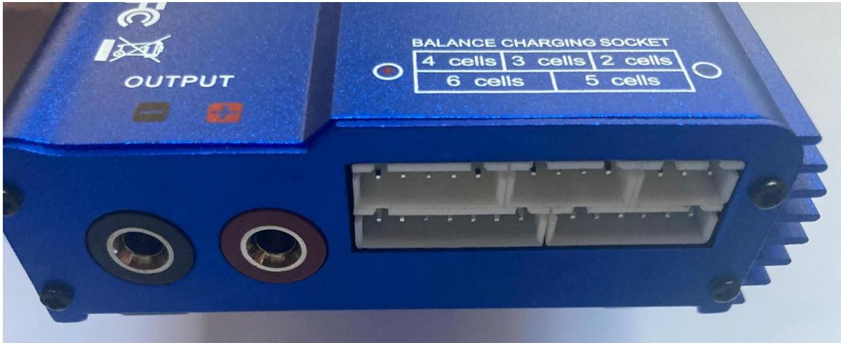
*Figura 45. Conectores JST-XH en función de las celdas de la batería.*
