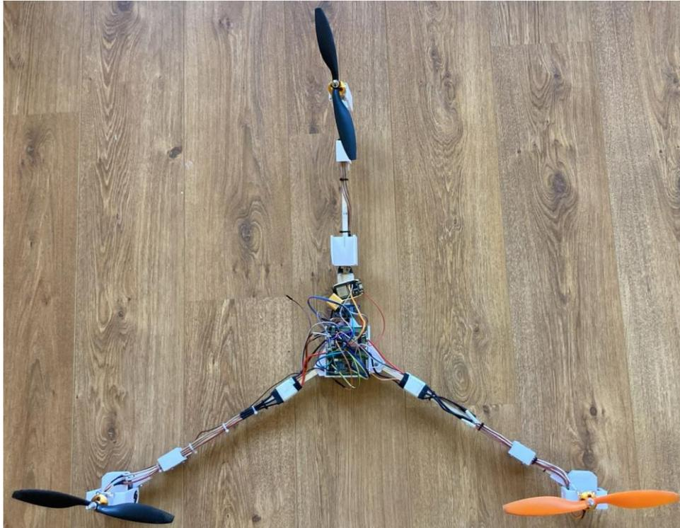
*Figura 71. Implementación final VTOL, vista completa.*
