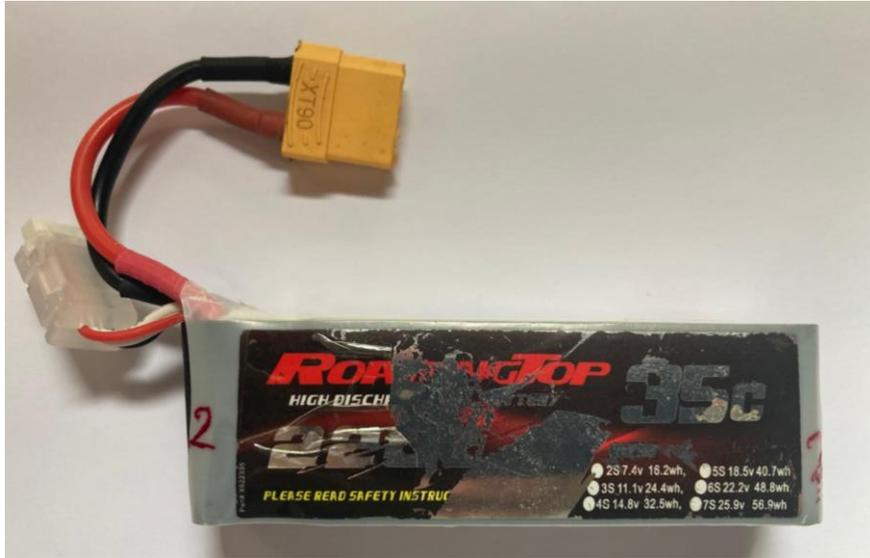
*Figura 43. Batería RoaRingTop 35c 2200mAh.*
