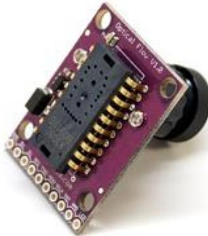
*Figura 34. Módulo de flujo óptico para el sensor ADNS3080*
