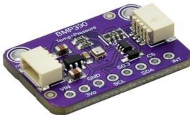
*Figura 32. Implementación circuital sensor BMP390.*
