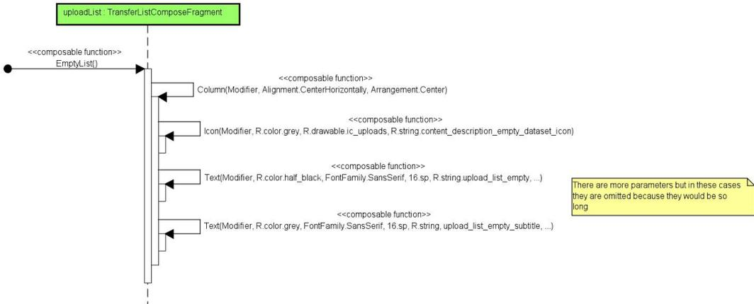
Figura 6.5: Diagrama de secuencia correspondiente a la función *composable* EmptyList
