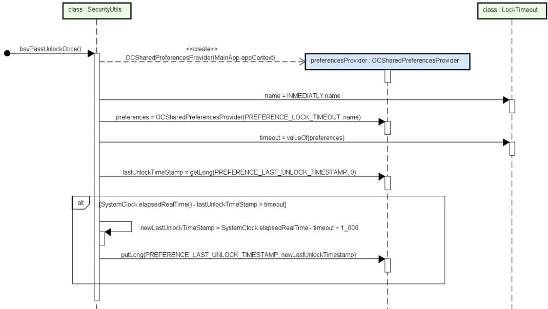
**Figura 5.5:** Diagrama de secuencia correspondiente a la función `bayPassUnlockOnce` de la Figura 5.4
