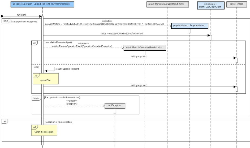
**Figura 5.21:** Diagrama de secuencia correspondiente a la implementación la función `run` de la Figura 5.20
