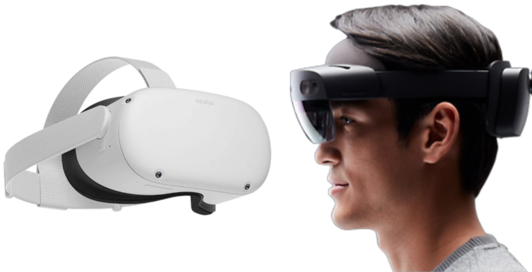
Figura 1.2: Meta Quest 2 para RV (izq.) y Microsoft HoloLens para RA (der.). Fuentes: Meta Quest 2 y Microsoft HoloLens
