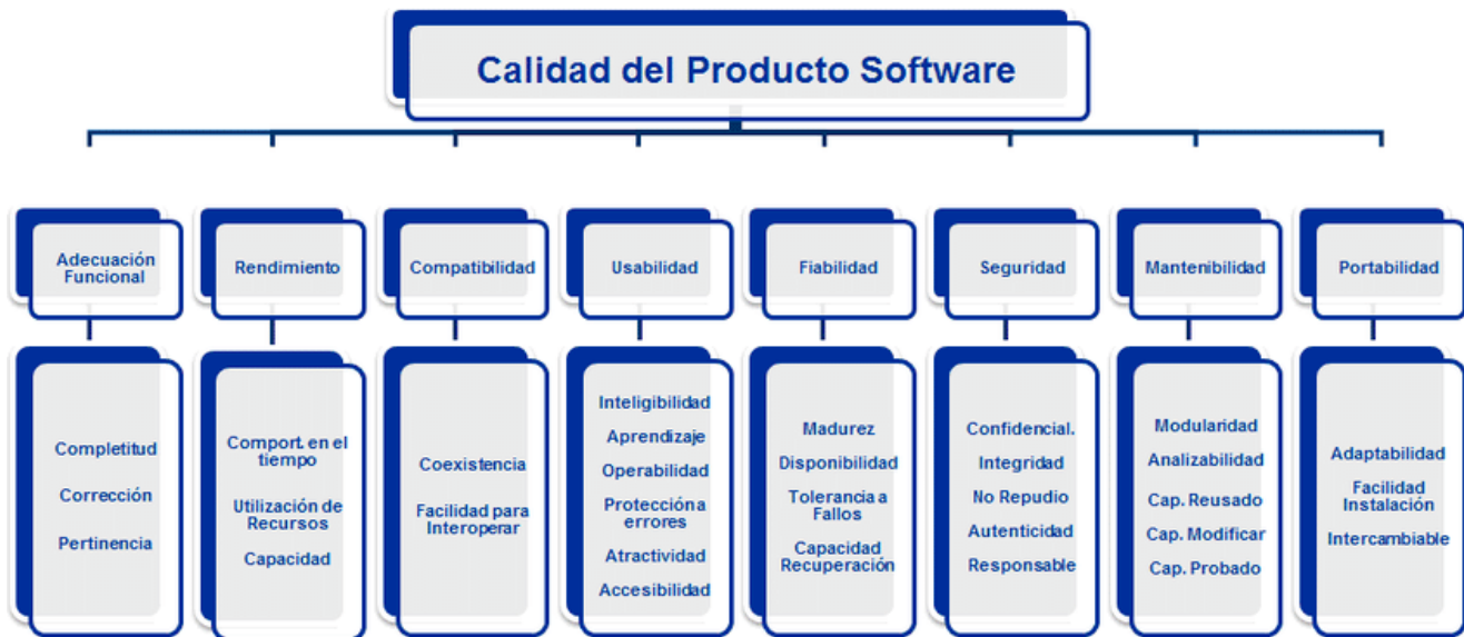
Figura 3.4: Dominios de la ISO 25010 para la calidad del software y los sistemas informáticos [81].
