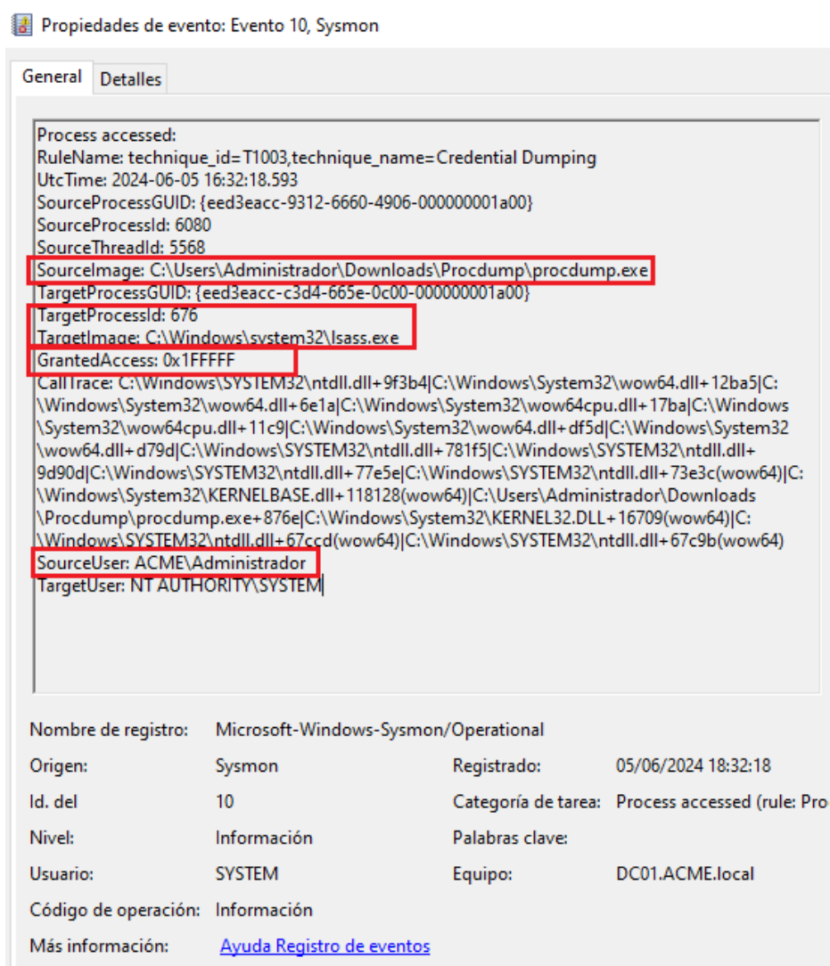
Figura 6.16: Evento generado al realizar el volcado de memoria del proceso LSASS utilizando ProcDump.
