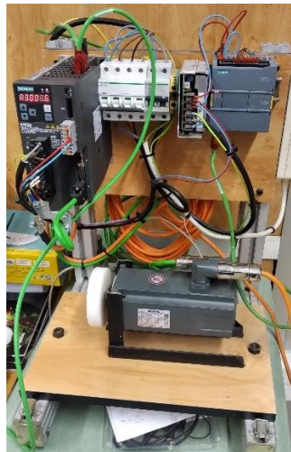
Figura 3 Maqueta servomotor PLC (elaboración propia)
