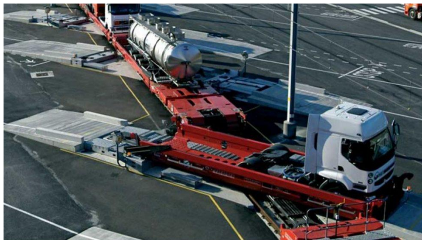
Figura 7. Sistema Modalohr. Recuperado de: https://www.viaa.com/es/
