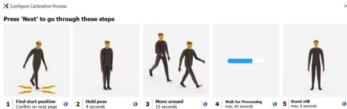
Figura 8. Pasos de la calibración N-pose
