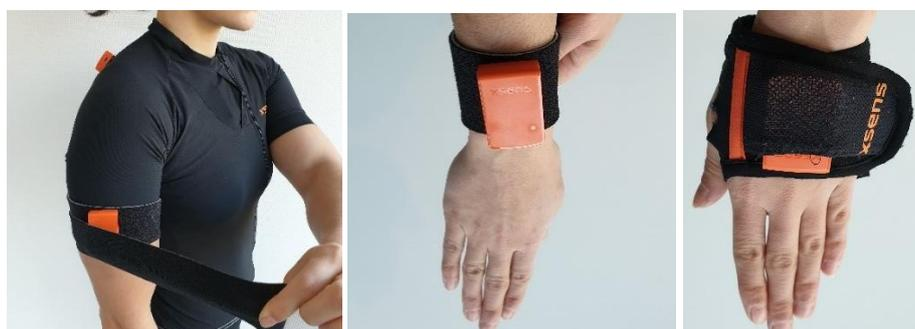
*Figura 4a, 4b y 4c. Colocación de los sensores de los hombros, brazos, antebrazos y muñecas (Movella, 2022)*
