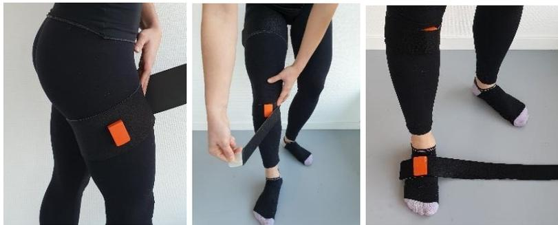
*Figura 6a, 6b y 6c. Colocación de los sensores de las piernas y los pies (Movella, 2022)*
