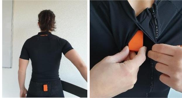
*Figura 5a y 5b. Colocación de los sensores de la pelvis y el esternón (Movella, 2022)*
