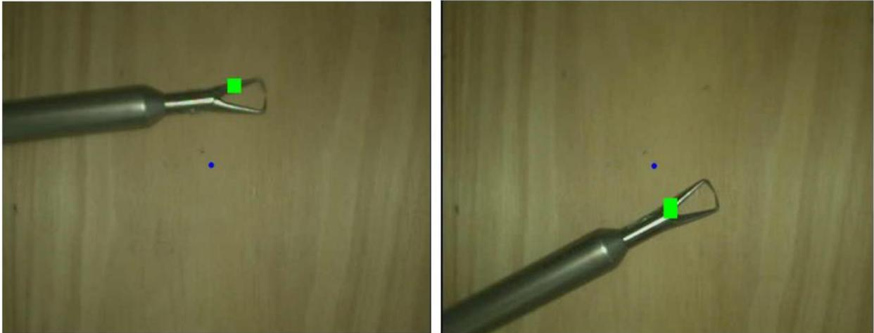
*Figura 17. Detección de herramienta de cirugía laparoscópica por el modelo de detección usando el endoscopio.*
