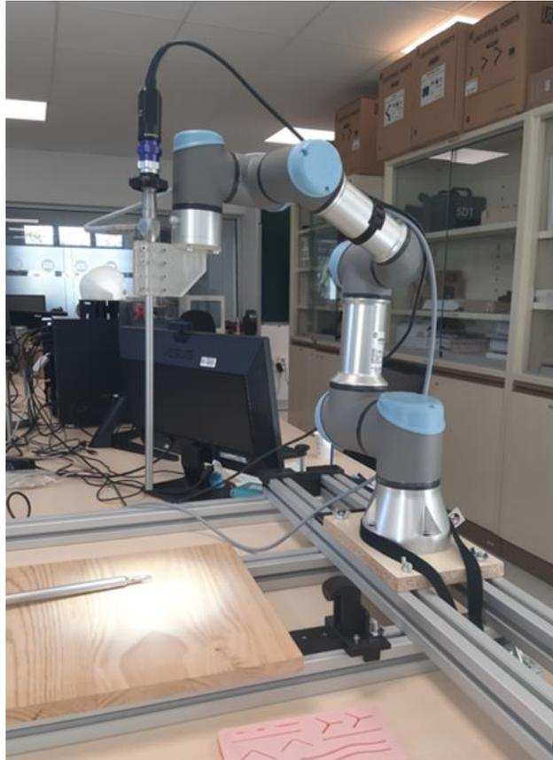
*Figura 26. Disposición del robot Ur3e con la óptica del endoscopio incorporada. Prueba 2.*
