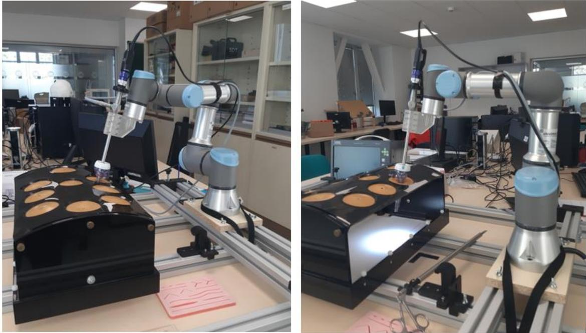
*Figura 27. Disposición del robot Ur3e con óptica de endoscopio incorporada e introducida en pelvitainer a través de trocar.*
