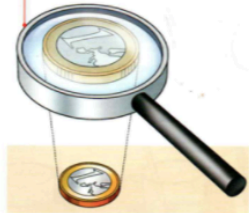
La lente convergente de una lupa desvía los rayos luminosos y hace que veamos los objetos ampliados.
