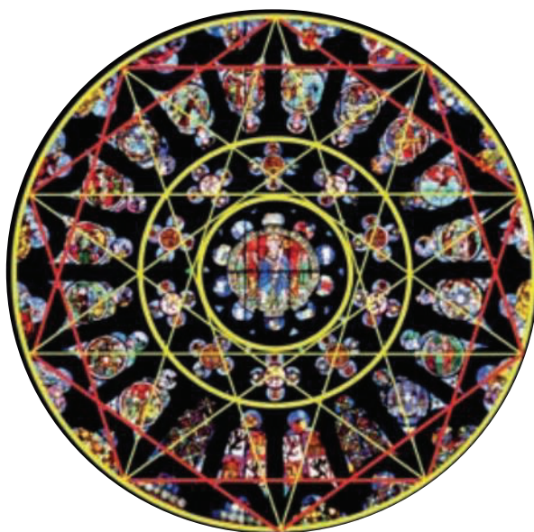
Fig. 15. Diseño geométrico del rosetón de la fachada del Sarmental. Fuente: De la Fuente Martínez, y García Velasco 2021, 519.
