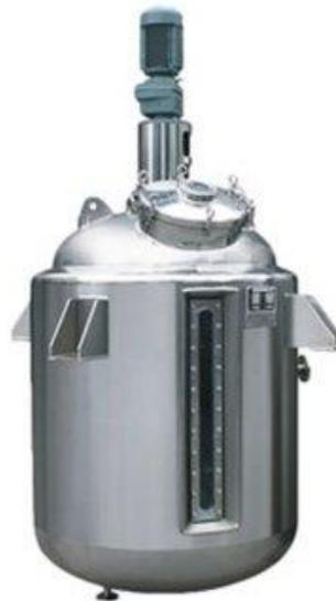
Figura 5: Reactor de explosión a vapor
