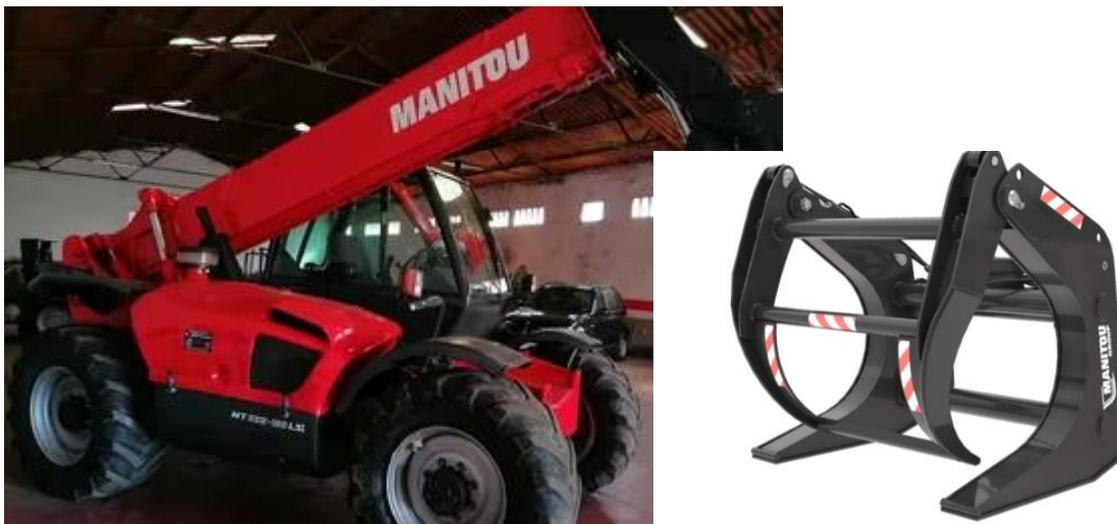
Imagen 8: Pala cargadora y acople para realizar las funciones en el parque de madera.
