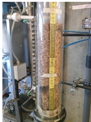
Figura 3.12. Fluidización en frío de la cascarilla de arroz tamaño natural
