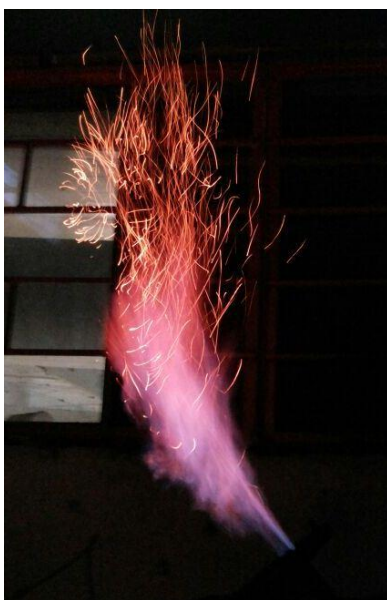
Figura 3.19. Llama de syngas producto de gasificación de la cascarilla de arroz con aire y vapor
