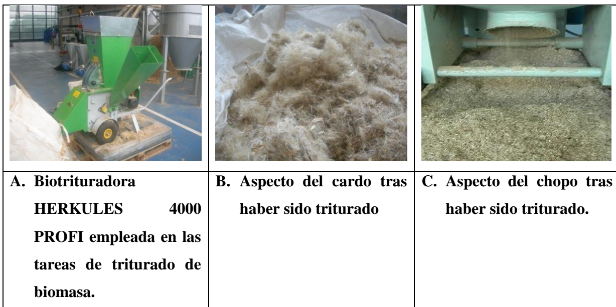
Figura 2.4 Máquina trituradora, aspecto del cardo y del chopo después de ser triturados
