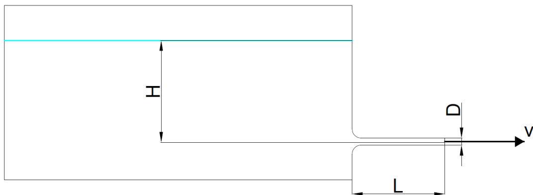
Figura 3-2 Depósito de agua que se vacía a través de un tubo de longitud L
