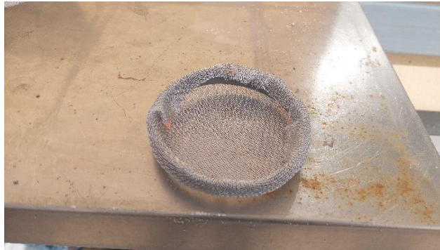
Figura 4-4 Malla metálica cubriendo al anillo
