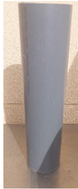
Figura 4-2 Tubo de PVC con L=450 mm
