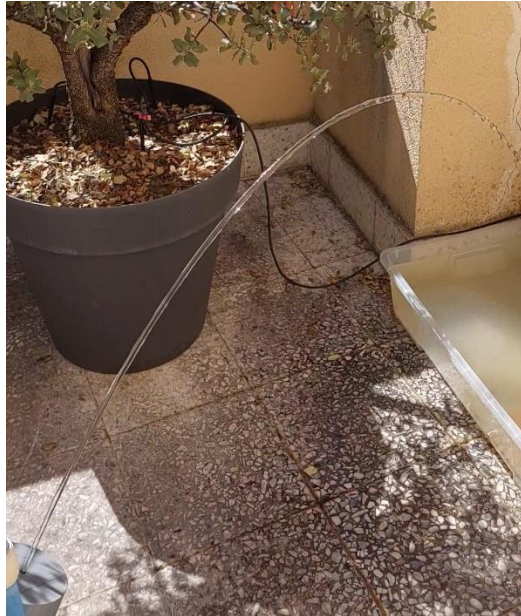
Figura 5-5 Chorro de flujo laminar que acaba en turbulento
