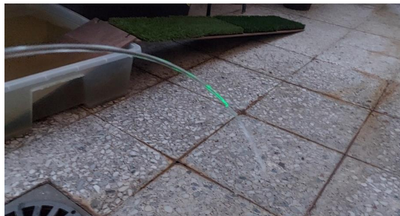
Figura 5-12 Luz del LED escapando del chorro turbulento
