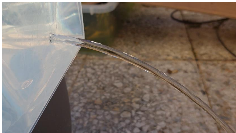
Figura 3-10 Vaciado de un depósito a través de un orificio con D=4 mm
