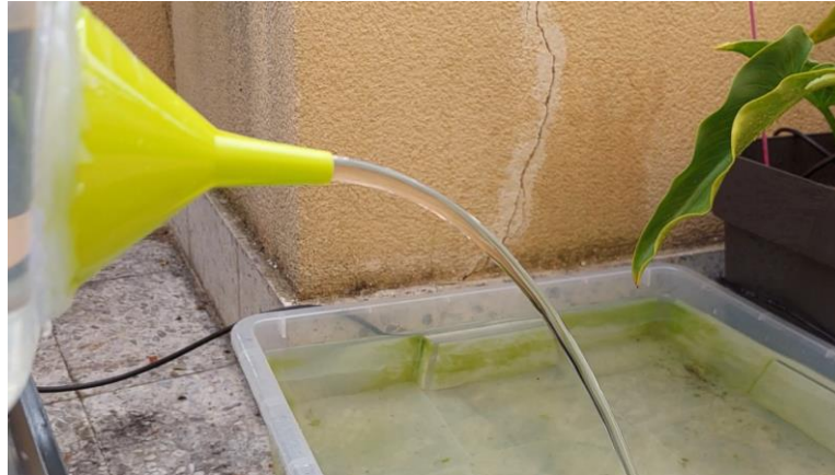
Figura 3-36 Flujo laminar en la salida de la segunda boca
