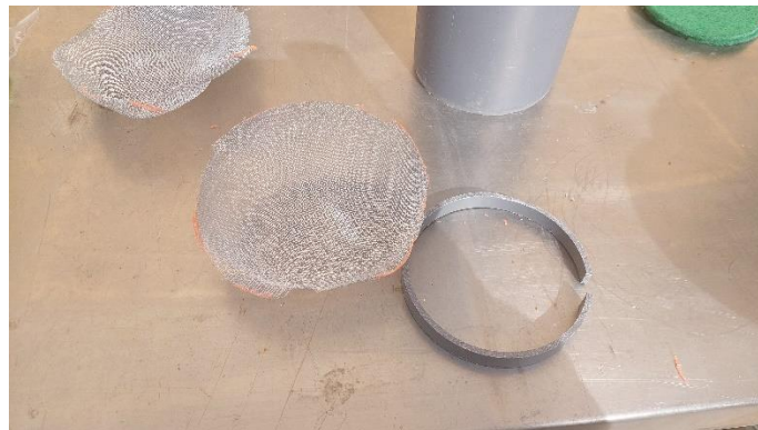
Figura 4-3 Anillo de PVC y malla metálica
