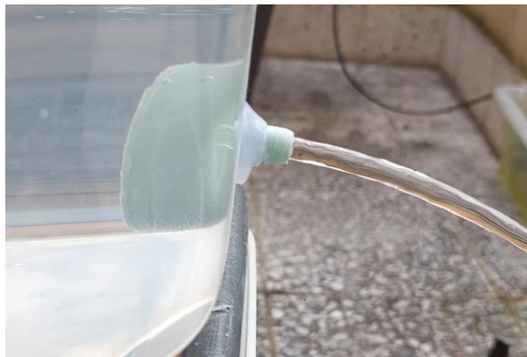
Figura 3-32 Salida del agua del depósito cerrado a través de la boca a una presión alta
