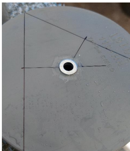
Figura 4-13 Tapa de PVC con arandela metálica pegada
