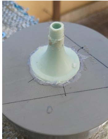
Figura 4-12 Tapa de PVC con boca pegada
