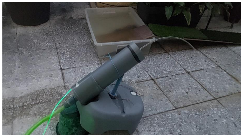
Figura 5-14 Chorro laminar proveniente del surtidor del que no escapa la luz del LED
