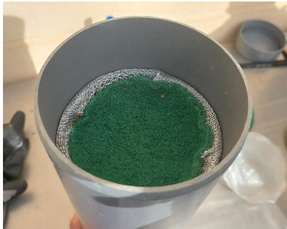
Figura 4-5 Tejido poroso en el interior del anillo y del tubo
