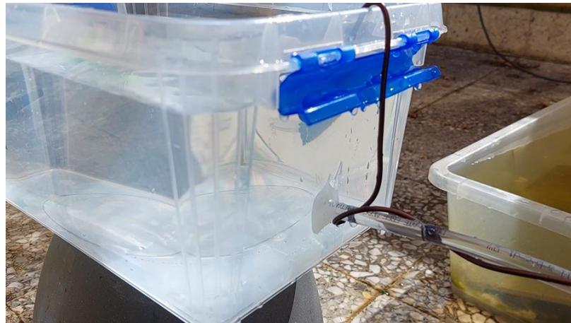
Figura 3-17 Depósito con un tubo con D=5\text{ mm} y L=500\text{ mm}
