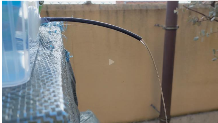
Figura 3-9 Vaciado de un depósito a través de un tubo
