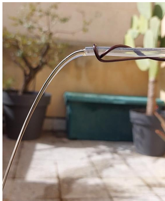
Figura 3-19 Salida del agua a través del tubo de D=5\text{ mm} y L=500\text{ mm}
