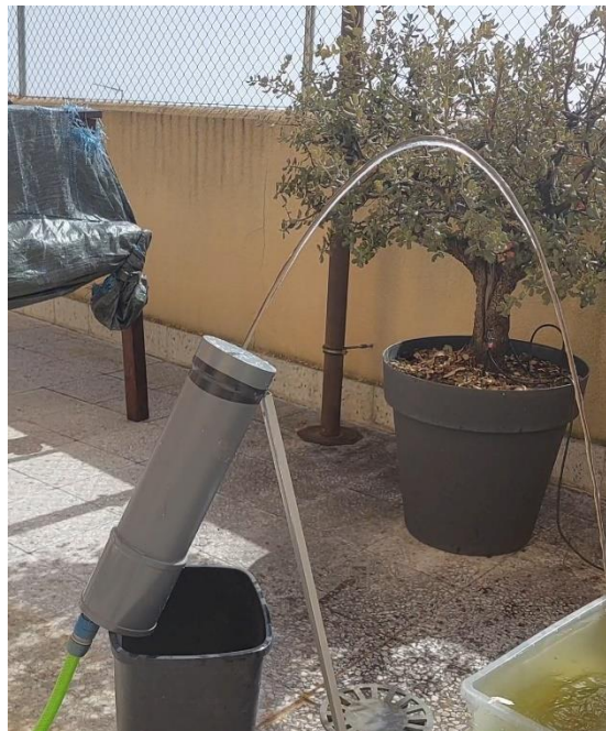
Figura 5-3 Chorro laminar arqueado
