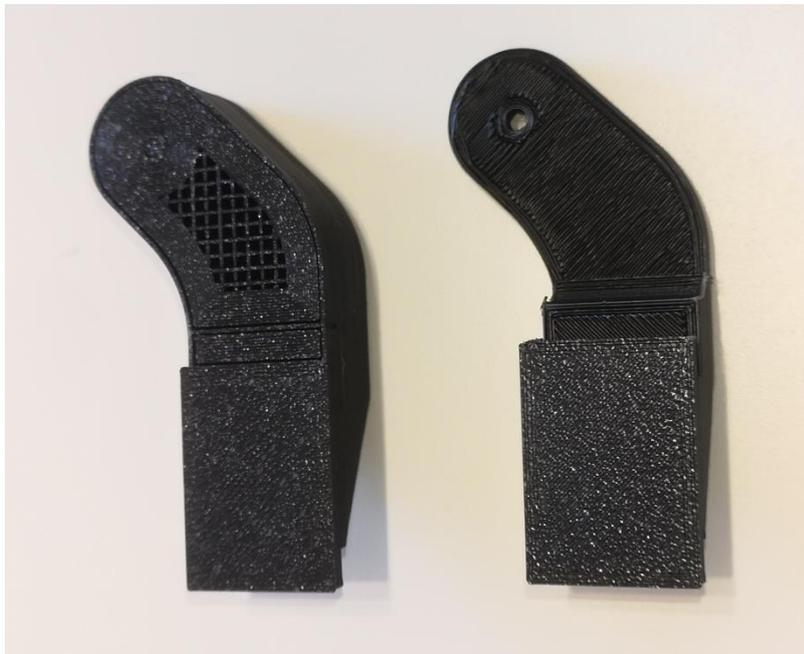
Figura 63. Pieza con soporte intacto (izq.) y con el soporte retirado (de). Elaboración propia
