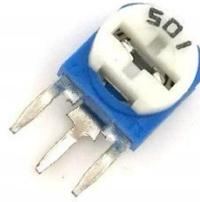
Figura 21. Potenciómetro. Fuente [21]
