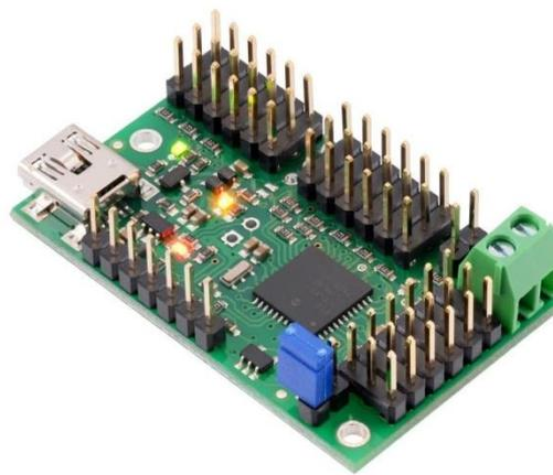
*Figura 20. Pololu Mini Maestro Servo Controller. Fuente [20]*
