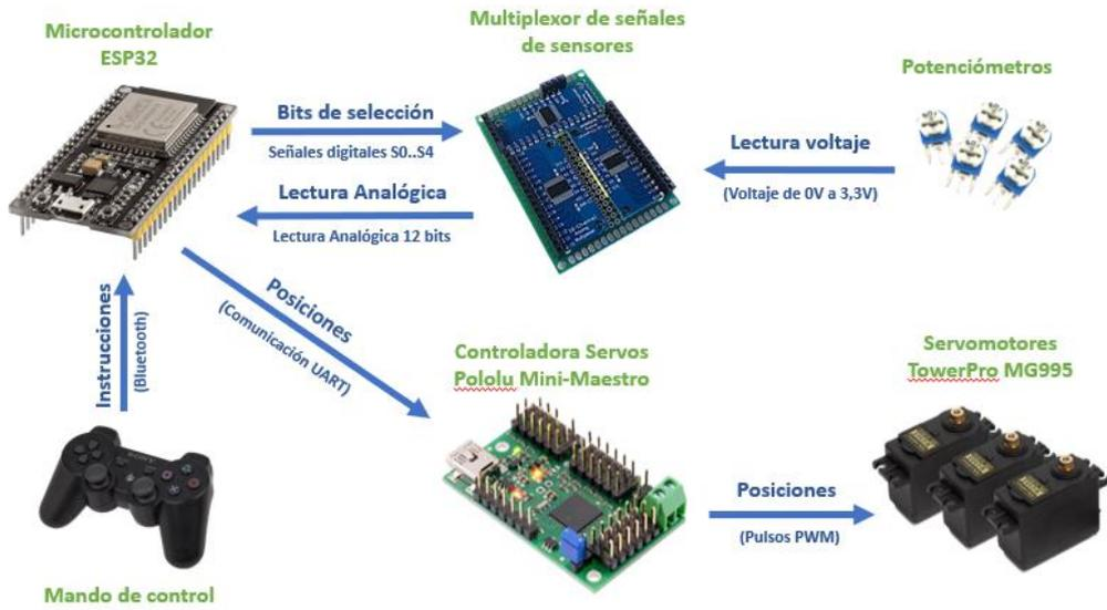
Figura 35. Esquema de señales de control. Elaboración propia
