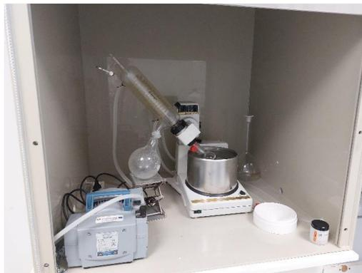
*Ilustración 6. Rotavapor utilizado para la reducción de volumen*
