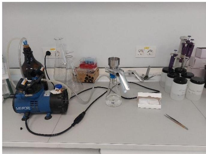
*Ilustración 7. Equipo utilizado para el filtrado formado tras la adición del metanol*
