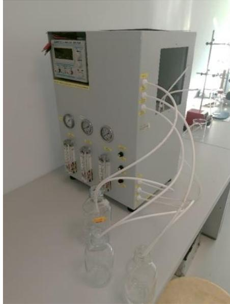
*Ilustración 7. Equipo de electrodiálisis*
