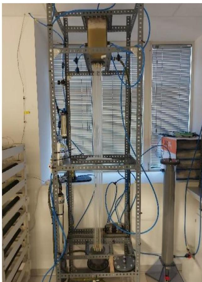
*Ilustración 4. Reactor de Flujo de Taylor para la producción de ectoína empleado en el laboratorio del Instituto en Procesos Sostenibles (Universidad de Valladolid).*
