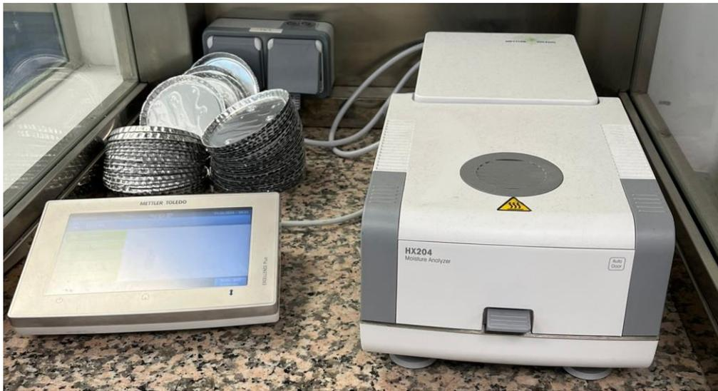
Imagen 3. Termobalanza analítica utilizada.
