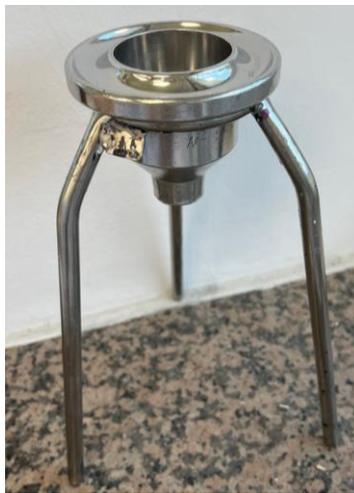
Imagen 2. Copa DIN4 utilizada en el experimento.
