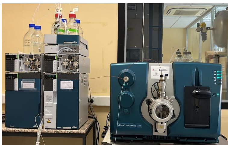
Figura 13. UHPLC-MS/MS empleado para determinación de las oxilipinas del Laboratorio de Técnicas Instrumentales.
