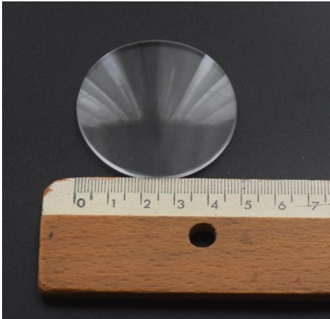
Imagen 1: Lente objetivo \text{Ø}\approx 50\text{mm} .
