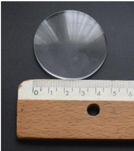
Lente objetivo \varnothing \approx 50\text{mm} .
