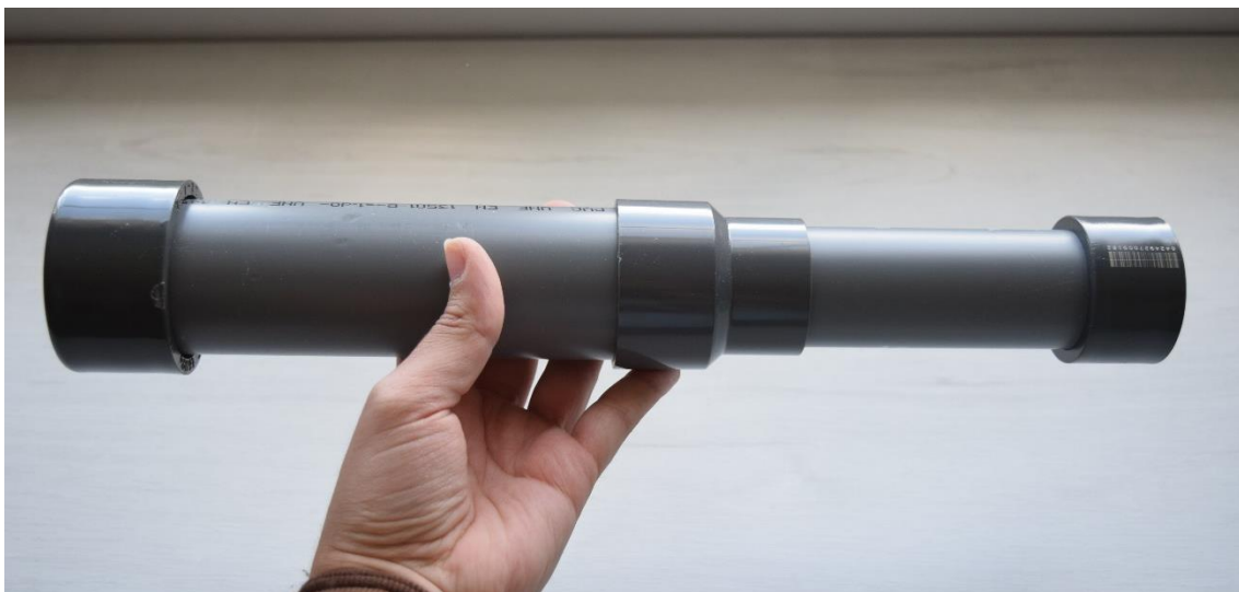
Fotografía 2: construcción final del telescopio astronómico de Kepler.
