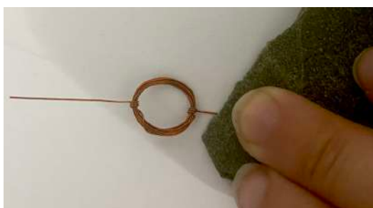
Figura 4. Lijamos la superficie visible de los terminales.
