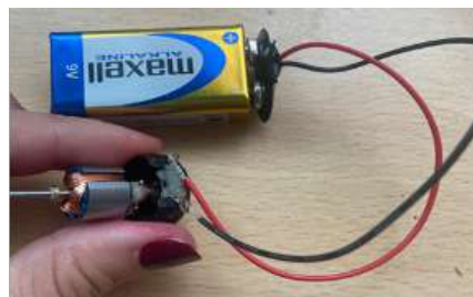
Figura 4. Fuente de alimentación conectada al rotor del motor.
