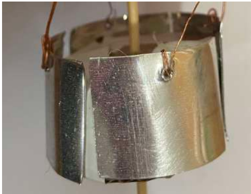
Figura 7. Conmutador del motor con las conexiones a las bobinas
