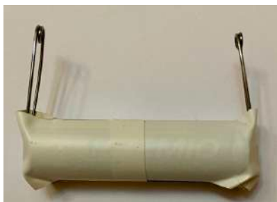
Figura 2. Soporte del arrollamiento conformado por la pila y dos imperdibles
