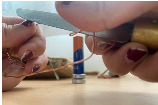
Figura 4. Retirada del esmalte del motor homopolar.
