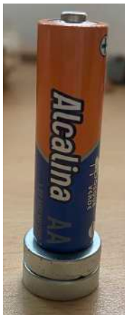
Figura 3 Pila con los imanes de neodimio en el polo negativo
