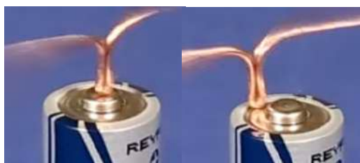
Figura 3. Conexión Terminal Positivo del Motor Homopolar. (Schmidt, W., 2023)
