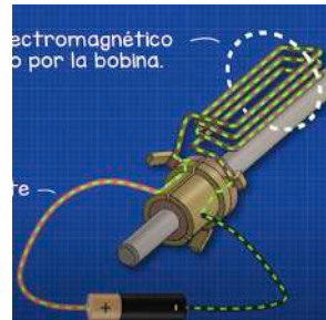
Figura 9. Flujo de corriente por una bobina aislada del rotor de un motor de corriente continua. (Mentalidad de Ingeniería, 2023, 7'35").
