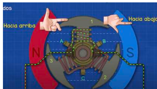
Figura 25. Esquema de fuerzas aplicadas a cada bobina en la posición 2. (Mentalidad de Ingeniería, 2023, 13'32")
