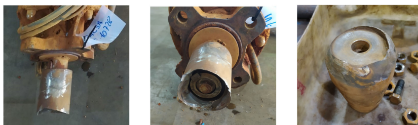
Figura A.2: Acoplamiento desgastado entre el motor y la bomba de Pedrizas2A [3]
