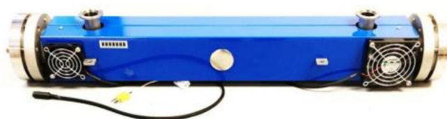
Figura 10: Celda de muestra con conducto de enfriamiento
