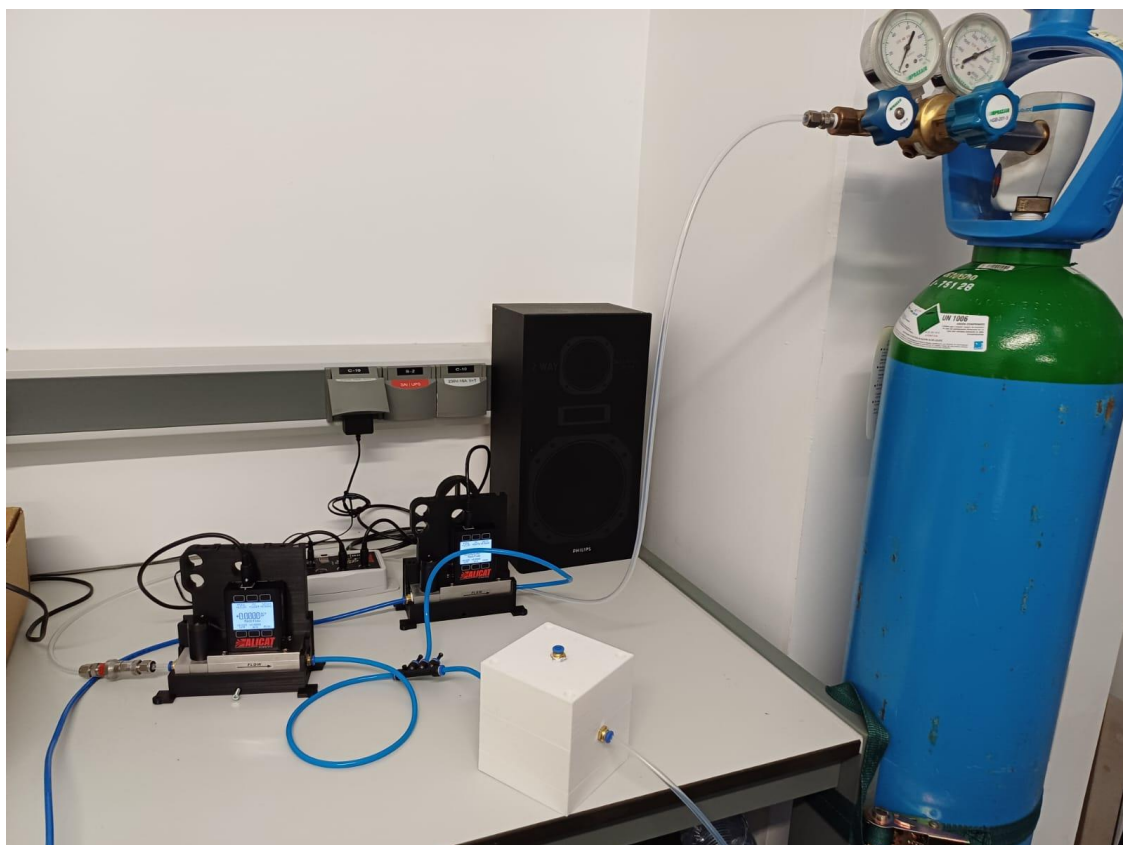
Figura 31: Dispositivo experimental de los controladores de flujo.
