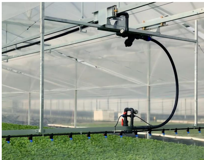
Figura 5. Carro de riego automático. Fuente. Casa comercial.
