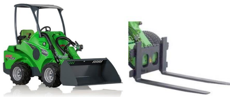
Figura 4. Mini pala cargadora y horquilla de palé para un rápido movimiento de la planta en el vivero. Fuente. Casa comercial.
