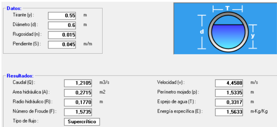
Imagen 4 Diseño de paso salvacunetas de PRFV situado en el PK 0+120 izquierda y derecha y PK 0+260 derecha, de 0,6 metros de diámetro y capaz de soportar un caudal de 1,21 m 3 /s
