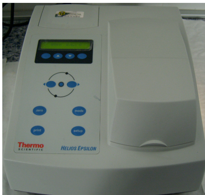
Figura M5. Espectrofotómetro Helios Epsilon utilizado para los métodos de Folin-Ciocalteu, CUPRAC y DPPH
