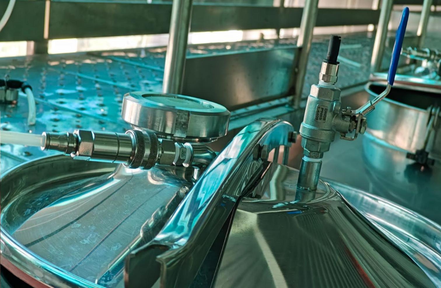
Fig. 13.8.- Pormenor da ligação de entrada de gás para a inertização do depósito e da válvula de saída de ar.
