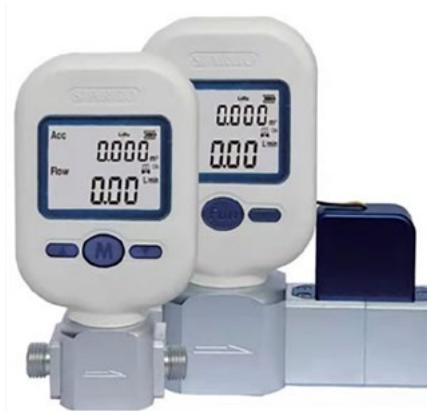
Fig 13.2. Medidor de caudal térmico digital Siargo MF5700 para medição de caudais mássicos de gás. Estão disponíveis versões para cada gás
