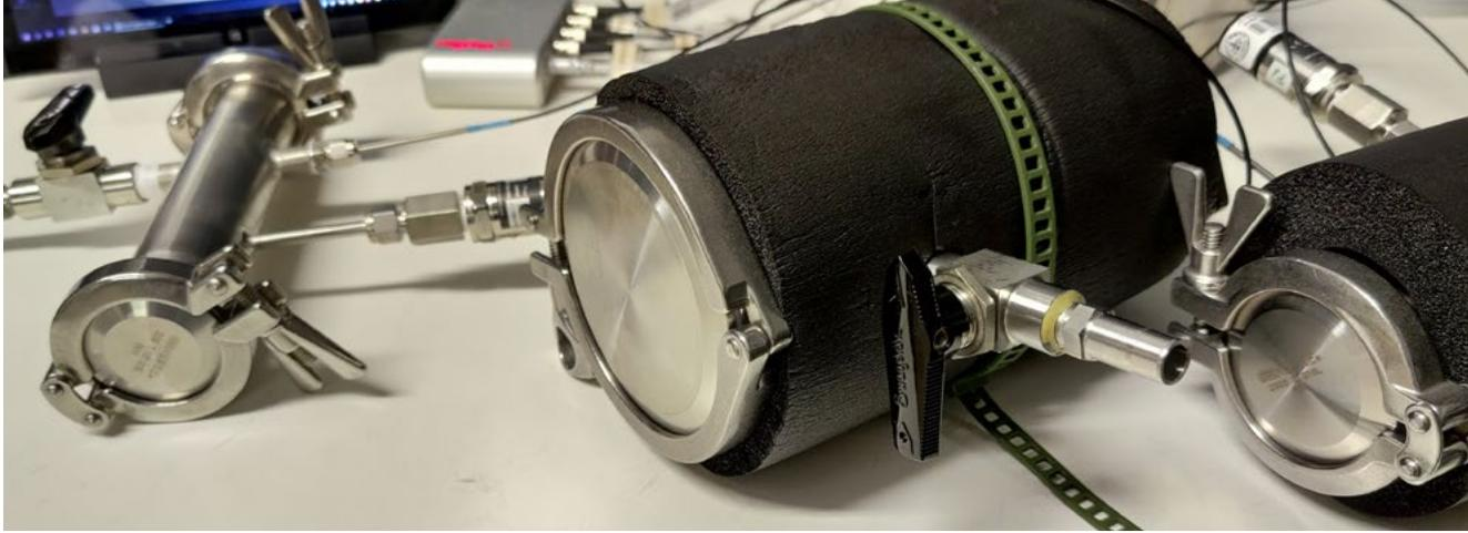
*Fig. 5.3.- Detalhe dos três tamanhos de conectores CLAMP testados (DN32, DN50 e DN80) com ambas as tampas cegas e onde o OTR foi testado para duas juntas.*
