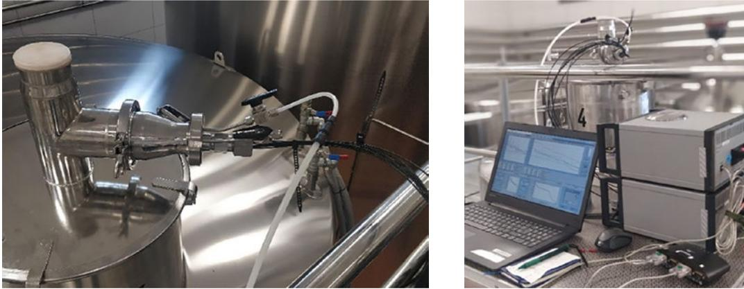
Fig. C.12.- a) Esquema da entrada das sondas e do gás de inertização juntamente com a saída de ar, b) Sistema de monitorização dos 8 canais de medição de oxigénio junto ao reservatório
