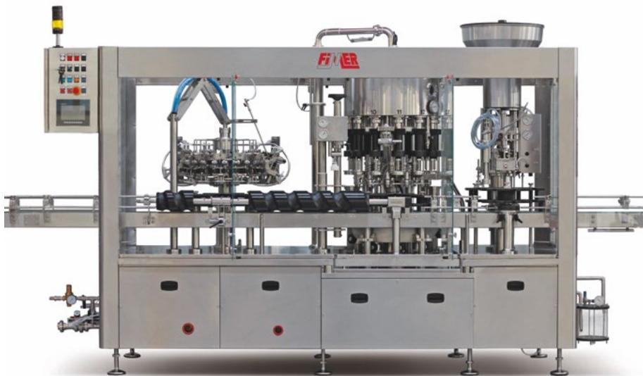
Fig. 9.6 - Máquina de engarrafamento FIMER com cabeça ANTIOX DEOX para injeção de gás inerte (Intecpro Solutions - Solutions in Wine and Sparkling Wine Production)<sup>19</sup>
