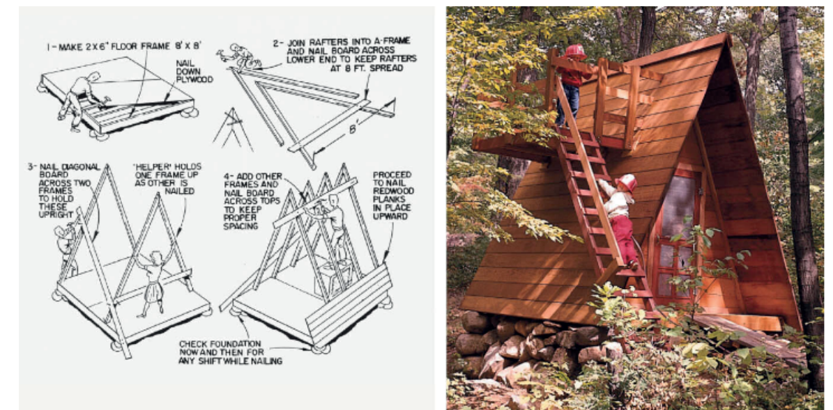
FIG. 47 - Proceso de construcción y obra finalizada FUENTE - A-Frame, Chad Randl
