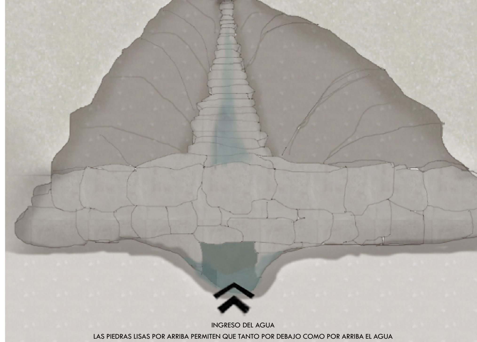
Ilustración 1. Estrategia del Manejo en los canales de riego de acuerdo a la técnica ancestral inca. Elaboración propia.
