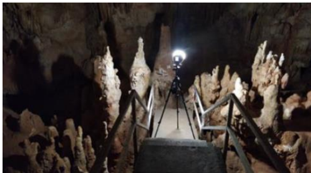
Figura 33. Escáner láser 3D terrestre con iluminación LED integrada. Fuente: Karkazi, E. et al. (2024).
