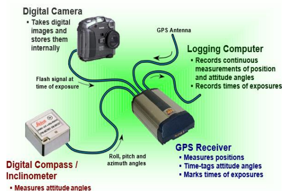
Figura 57. Configuración simple de un sistema primario Backpack MMS. Fuente: Ellum, C. M., & El-Sheimy, N. (2001).
