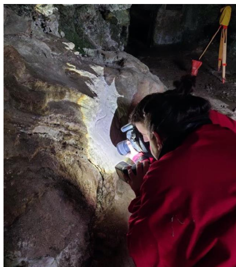
Figura 29. Toma de datos fotogramétricos con foco de apoyo manual. Fuente: García Bustos et al. , (2023).
