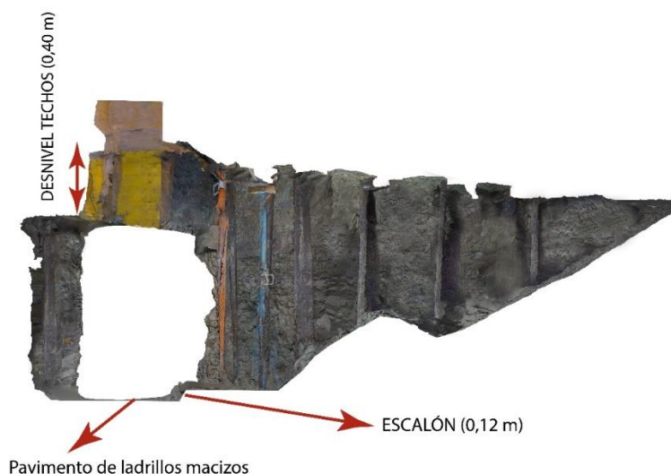
Figura 110. Ortoimagen en sección de la Galería 1, señalando desnivel en techo, escalón y pavimento.
