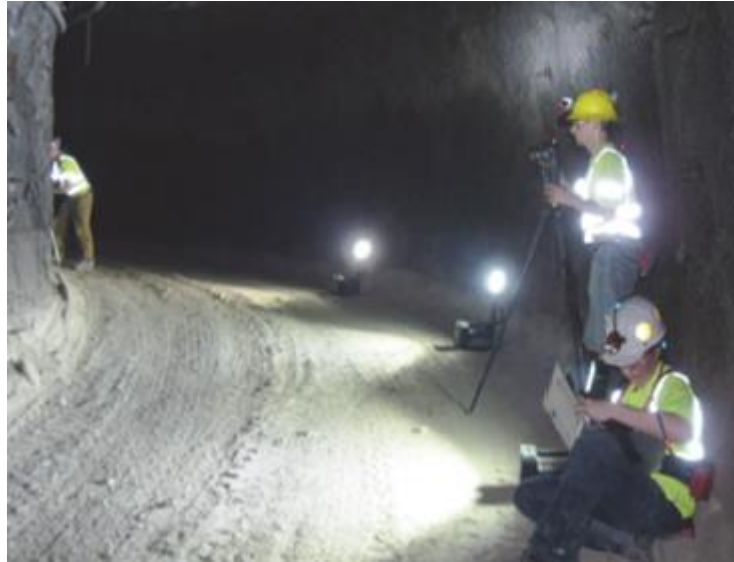
Figura 27. Estudio fotogramétrico realizado en la rampa 54 de la mina Lucky Friday. Fuente: Benton, D. J. et al. (2017).
