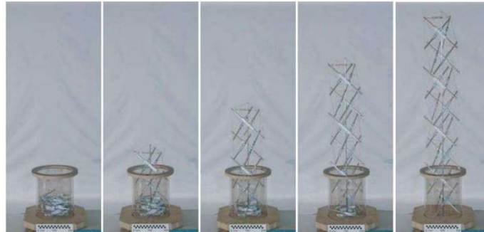
Figure 9 9 - Ex : Inflatable Antenna Experiment placée par la NASA, Jet Propulsion Laboratory (JPL)
