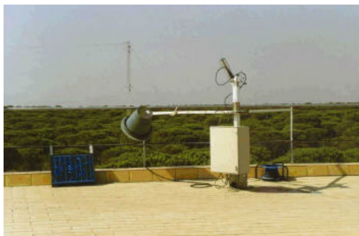
Figura IV.3: El Cimel, perteneciente a la red AERONET, en la terraza de medidas de El Arenosillo.
