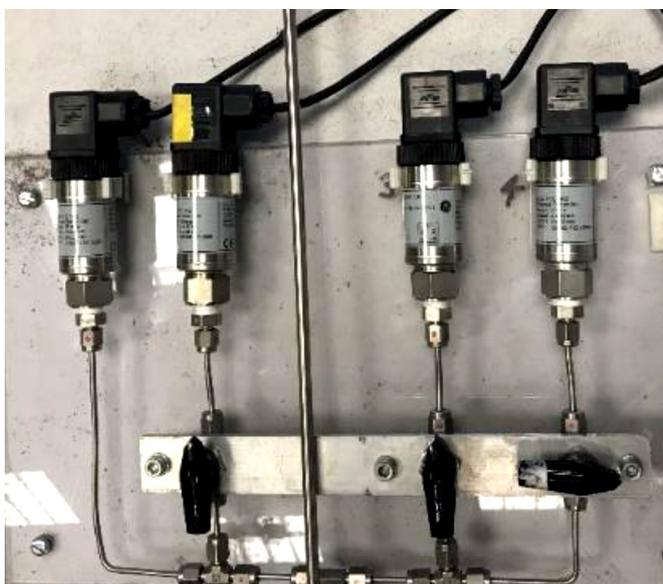
*Figura 3.3. Imagen de los captadores de presión para medir la presión interior de la BCVC sin combustión.*
