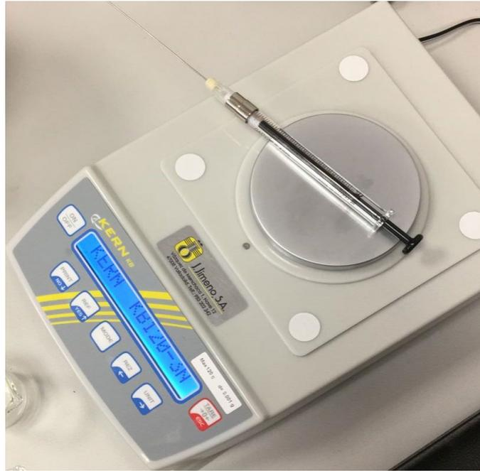
Figura 3.6. Balanza, jeringa y aguja empleadas para la medición e introducción de combustibles líquidos en la BCVC.
