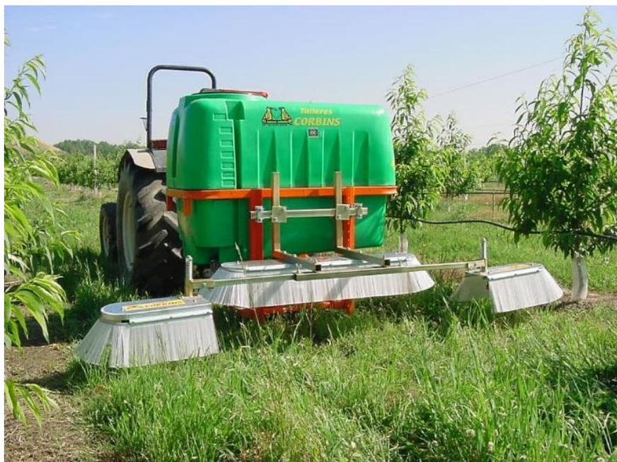
Ilustración 1: Máquina pulverizadora de interfilas
