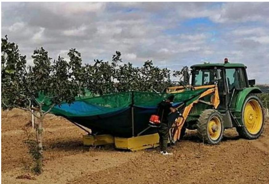
Ilustración 16: Vibrador de troncos con paraguas invertido acoplado a tractor
