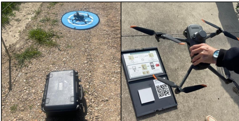
Figura 17. Dron DJI Mavic 3M en los muestreos de la parcela de Viñalta.
