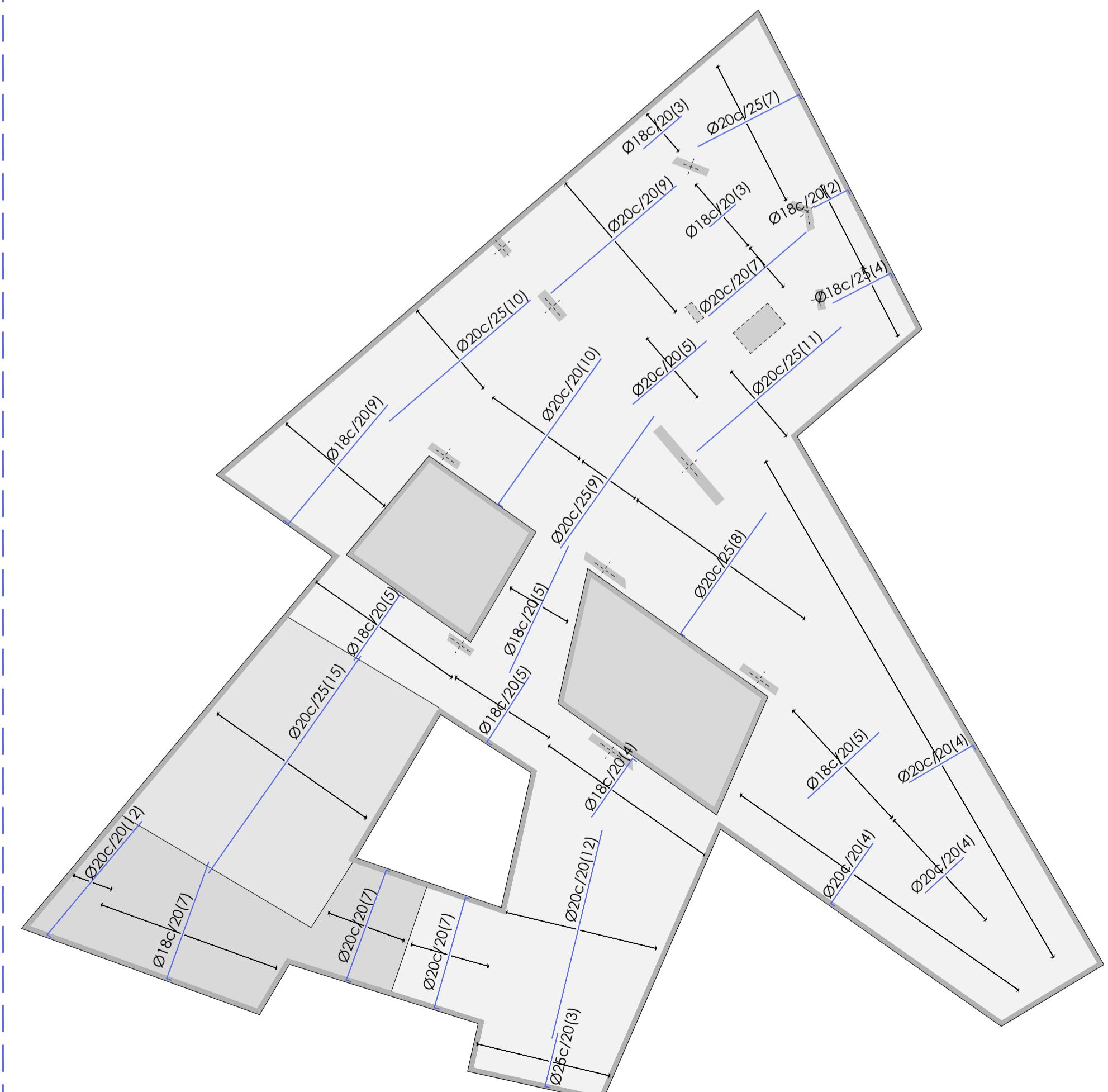
LOSA CIMENTACIÓN ARMADURA LONGITUDINAL INFERIOR - E 1:250
