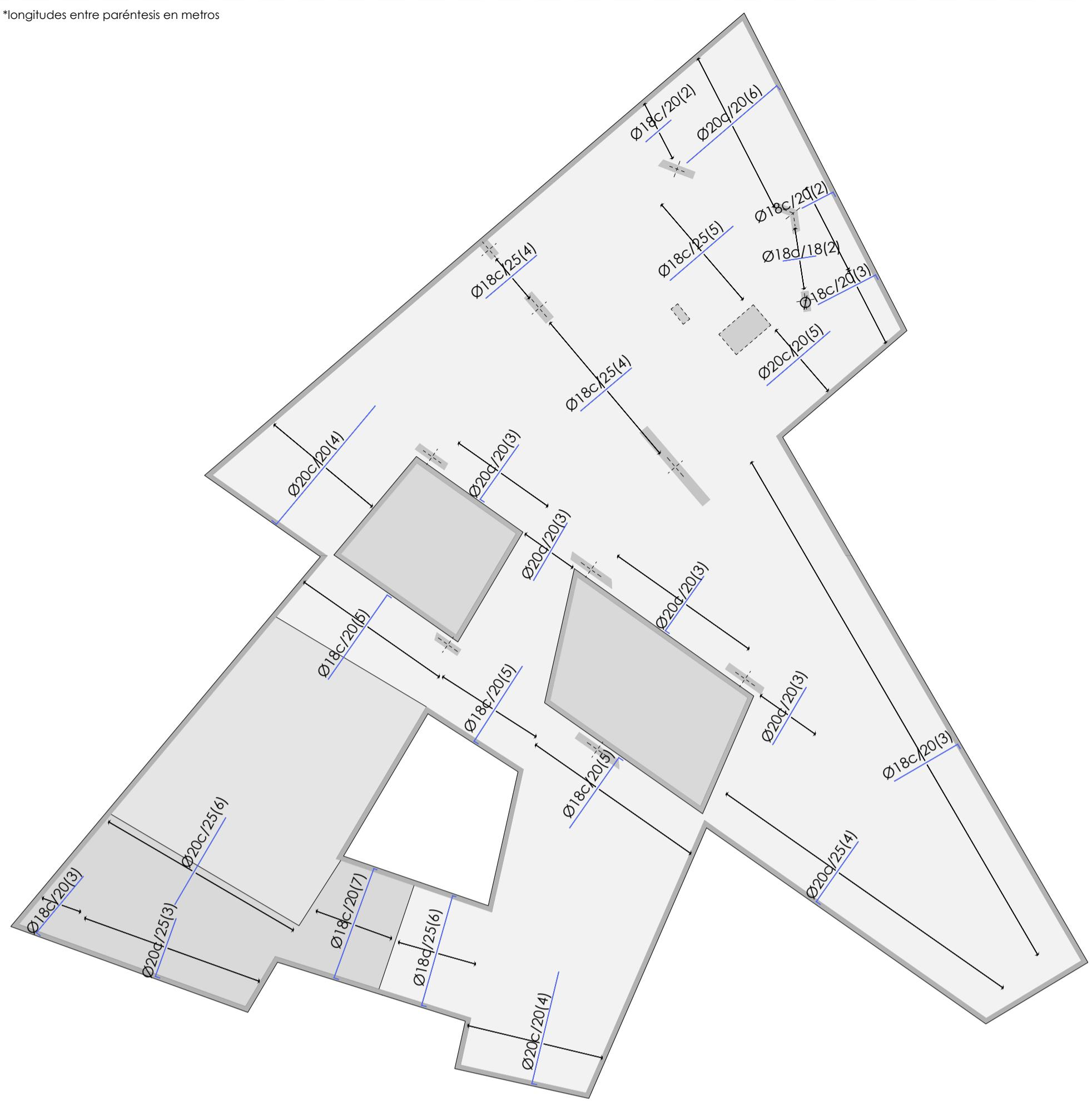
LOSA CIMENTACIÓN ARMADURA LONGITUDINAL SUPERIOR - E 1:250
