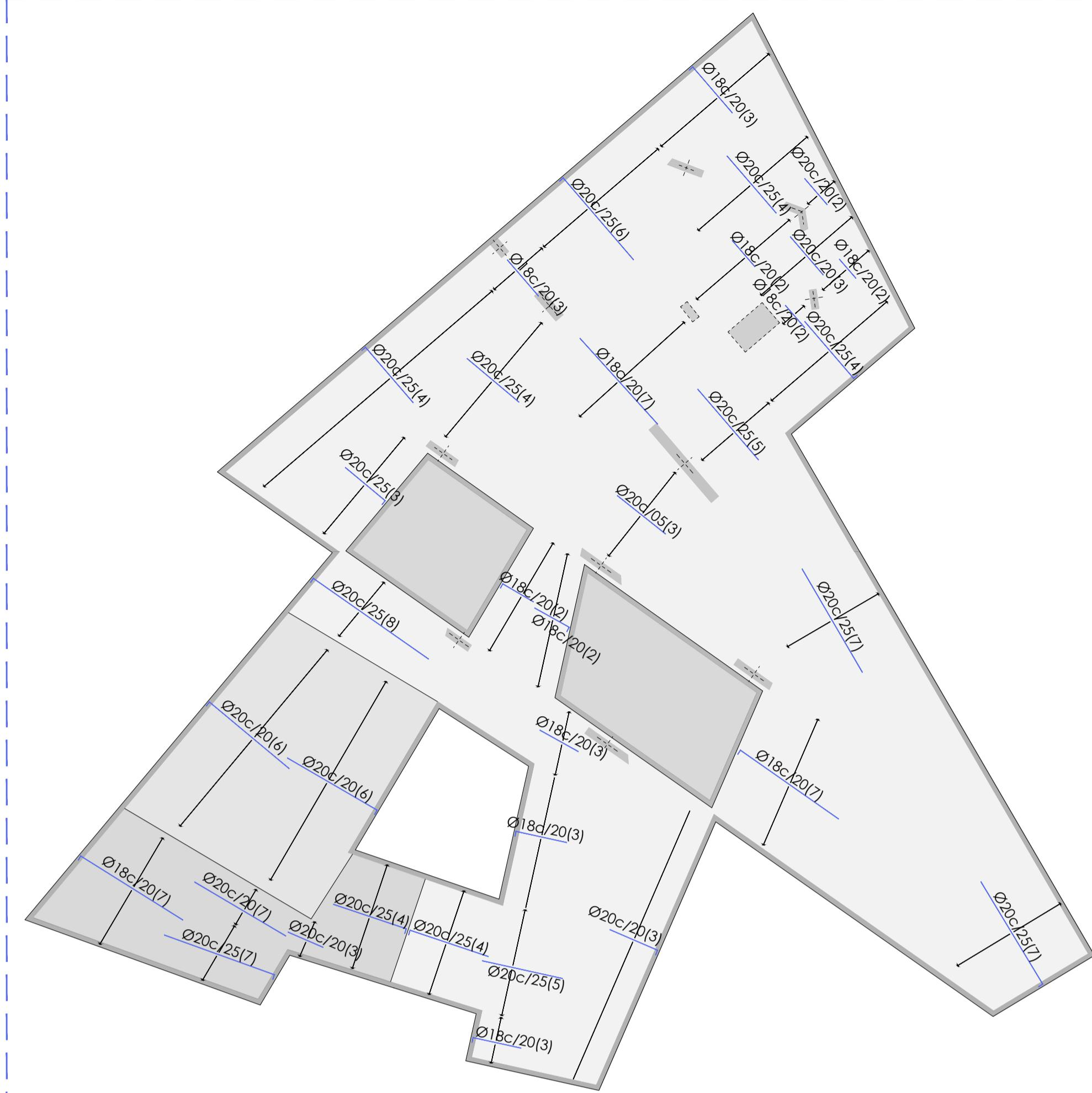
LOSA CIMENTACIÓN ARMADURA TRANSVERSAL SUPERIOR - E 1:250
