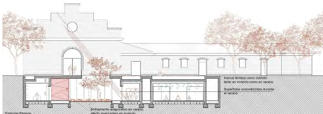
Fig. 14 Esquema en sección de los sistemas pasivos.
