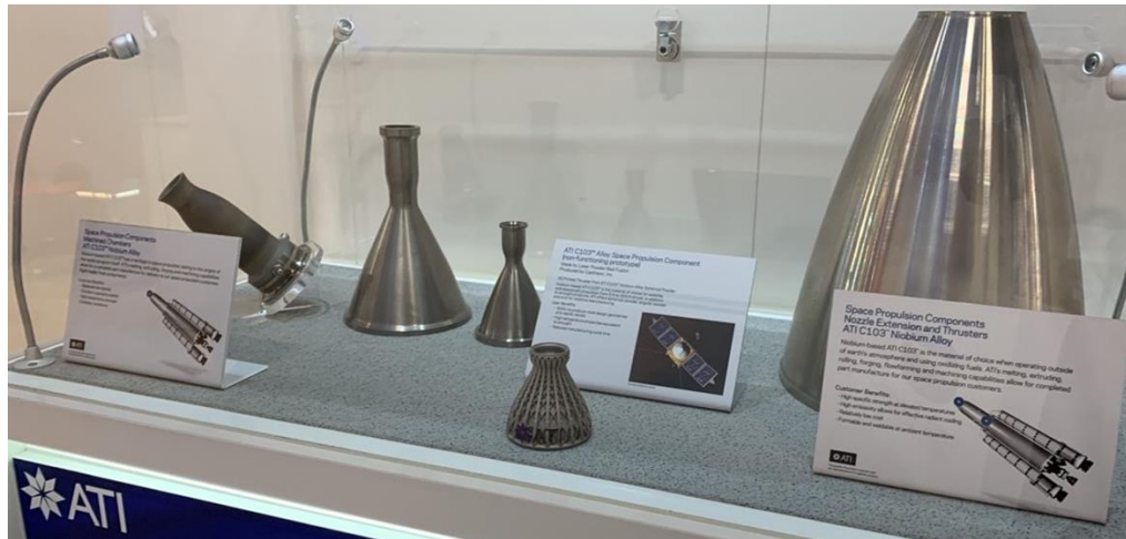
Fig. 47 Ejemplos de componentes fabricados mediante L-PBF y EBM de material C-103 [26]
