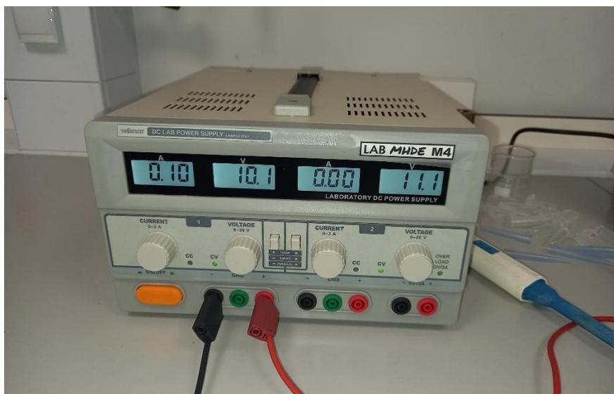
*Ilustración 73. Fuente de tensión utilizada durante los ensayos preliminares.*
