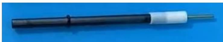
*Ilustración 71. Electrodo de grafito usado en el cátodo durante los ensayos de electrofermentación [30].*
