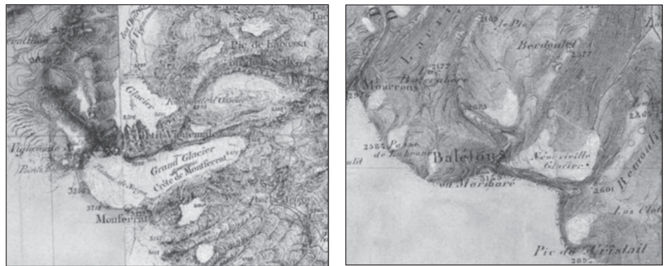
Figura 4.6. Extractos de la Carte de Etat Major francés, con la representación de los glaciares en el Vignemale, a la izquierda, y Balaitous, a la derecha. Se aprecia ya una representación realista de la forma y extensión de los glaciares (fuente/source gallica.bnf.fr/BnF)
