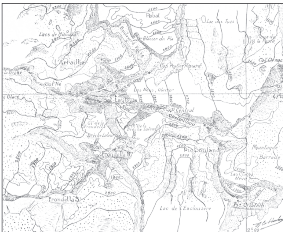
Figura 4. 27. Extracto del mapa Glaciers de Balaitous a escala E.1/20.000 en el original, de A. Meillon, representando los glaciares con curvas de nivel, equidistancias de 100 m y paredes dibujadas mediante líneas horizontales (fuente/source gallica.bnf.fr/BnF)
