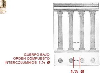
Las relaciones formales de la fachada las resuelven los órdenes, la estructura de la biblioteca la resuelve el muro, y la belleza la aportan los órdenes que, mediante el retranqueo de los entablamentos hacia el muro, reflejan en él su belleza. Un singular equilibrio entre ambos sistemas.
