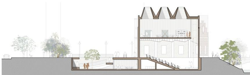
El segundo vacío significativo es el patio de acceso en planta sótano, al que se accede mediante la rampa helicoidal desde la plaza. Este espacio excavado no solo cumple una función de transición vertical accesible, sino que actúa como un filtro climático y acústico, reforzando la sensación de recogimiento al entrar en el edificio. La iluminación natural, que baña este patio de forma controlada, crea un ambiente templado y sereno.
