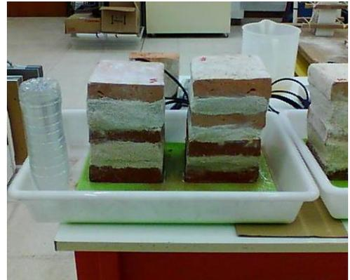
ENSAYO DE SUCCIÓN A UNA PROBETA DE FÁBRICA DE LADRILLO
