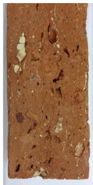
SECCIONES DE LADRILLOS: DE TEJAR ANTIGUO (ARRIBA) Y EXTRUSIONADO MODERNO (ABAJO)
